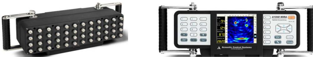
**Abbildung 3: Ultraschallgerät basierend auf Transversalwellenanregung durch trocken angekoppelte Punktkontaktprüfköpfe und Auswertung auf Grundlage eines Sampling-Phased-Array-Algorithmus.
