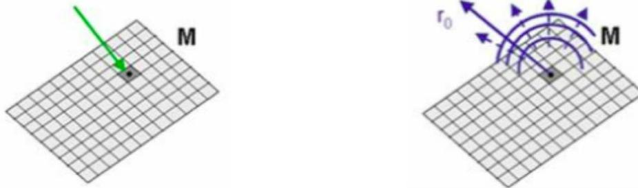
Abbildung 6: Prinzip zur Erfassung der Interaktion eines einfallenden Wellenstrahls mit Grenzflächen in CIVA [28] nach Kirchhoff.
