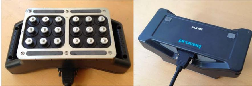
**Abbildung 2: Ultraschallgerät basierend auf Transversalwellenanregung durch trocken angekoppelte Punktkontaktprüfköpfe, von denen je neun Stück als Sendergruppe und neun Stück als Empfängergruppe parallel geschaltet arbeiten, resultierend in einem S/E-Prüfkopf.
