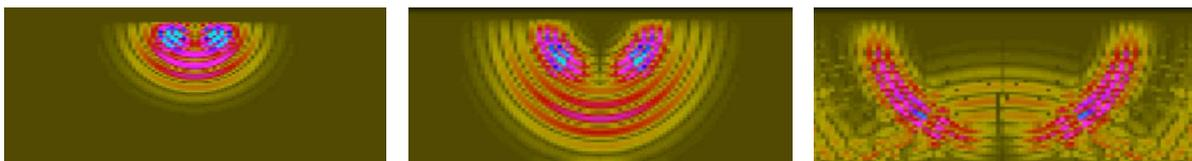
**Abbildung 8: Simulation der Schalldrücke als Zeitschnitte unter Berücksichtigung der Interaktion mit den Bauteilgrenzflächen in der semi-analytischen Simulationsplattform CIVA.**
